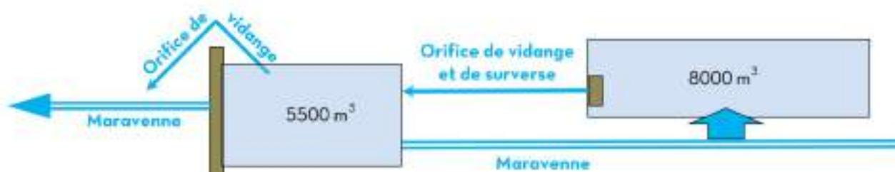
Ce fonctionnement permet d'absorber une partie de l'hydrogramme de crue produit par le Maravenne pour une pluie courte (1h) d'occurrence vicennale et de décaler suffisamment le pic de crue pour effacer l'incidence du ruissellement produit par l'urbanisation du secteur Valcros rive droite pour cette pluie de projet.
