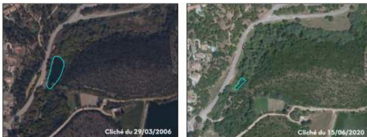
Bien que présentant une grande capacité, les volumes de retenues A, B et D ne sont pas intégrés au modèle hydrologique du bassin versant du Maravenne car ceux-ci n'ont pas de vocation d'écrêteur de crue, mais d'ouvrage de stockage d'eau. Ces retenues sont donc susceptibles d'être pleines en cas d'évènement pluvieux.
