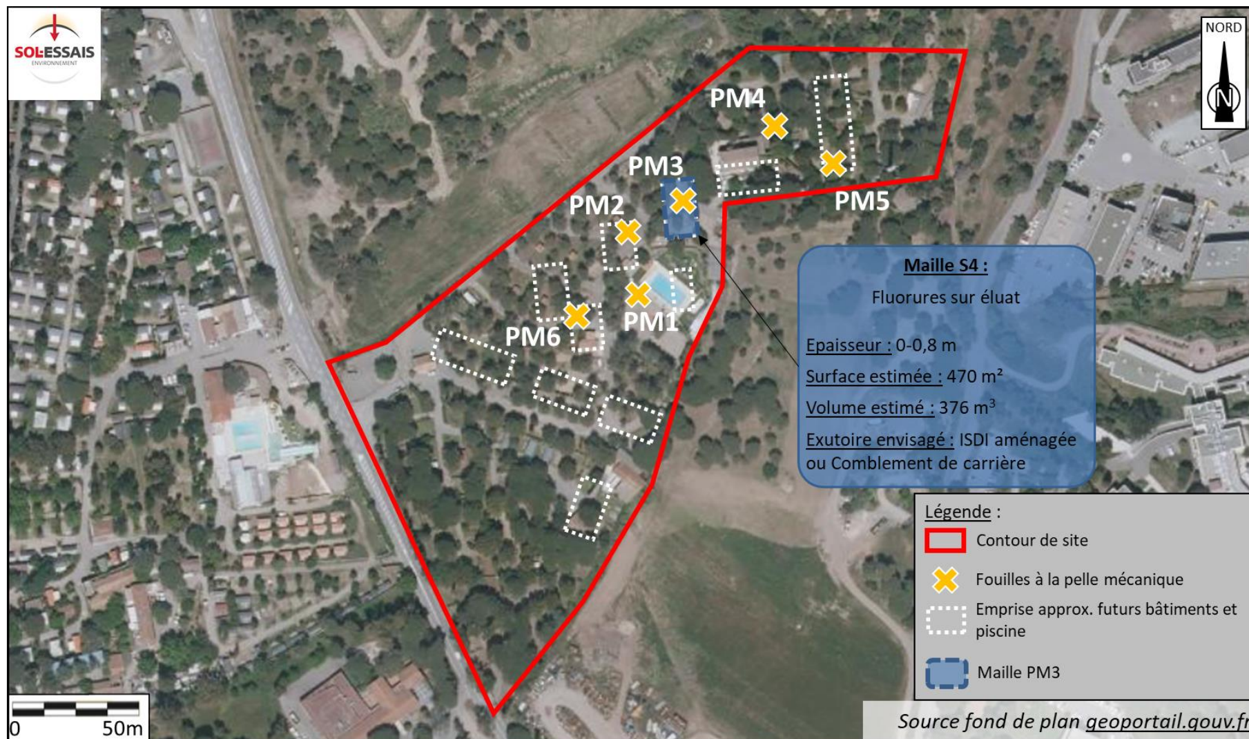
Figure 17 : Emprise de la maille de terres non inertes PM3 (janvier 2022)
