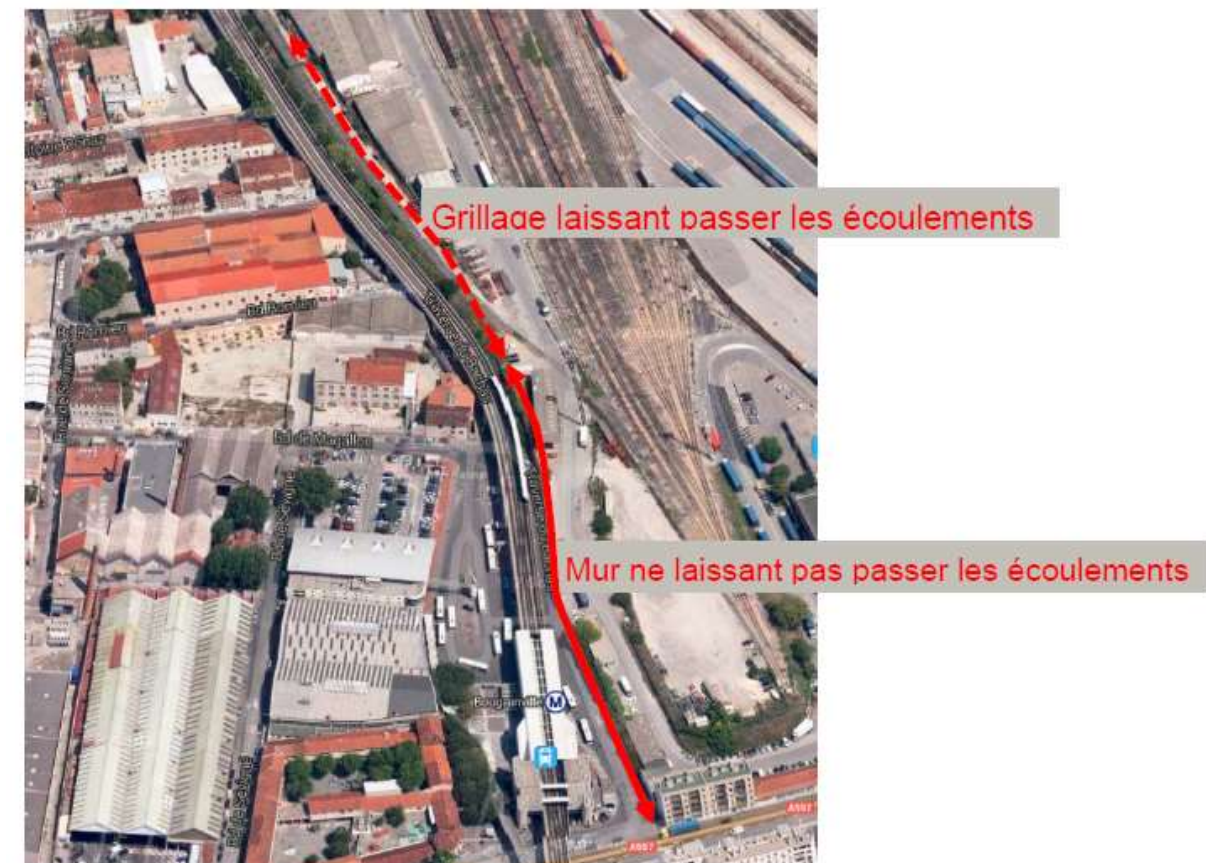
Mur de séparation entre le métro et le faisceau du Canet, source Etude de connaissance de l'aléa inondation sur le bassin versant des Aygalades
