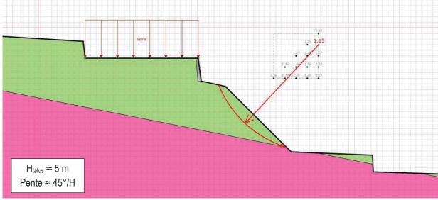
Dans les zones où la pente ne pourra être adoucie, comme c'est le cas au droit du profil n°3, un confortement de talus (paroi clouée par exemple) ou un ouvrage de soutènement devra être envisagé.
