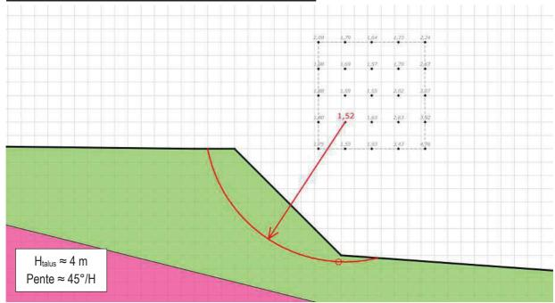
Les notes de calculs sont reportées en annexe 6. L'ensemble de ses calculs ont été réalisé sans coefficient partiel (calcul unitaire), et sans paramètre sismique, afin d'assurer la stabilité avec une sécurité suffisante, les coefficients visés sont donc :
