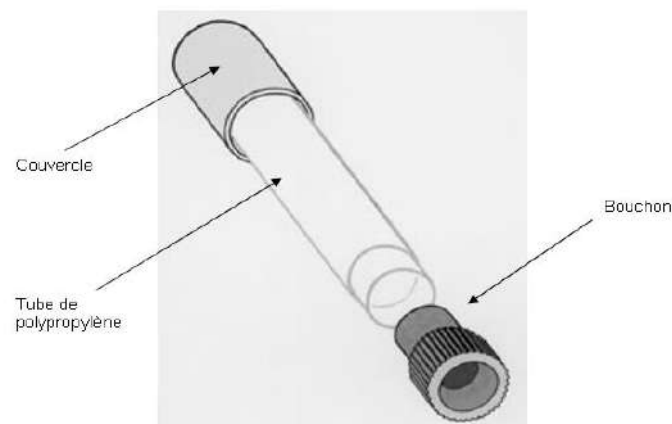
Figure 248 : Echantillonneur passif pour le dioxyde d'azote (Passam)
