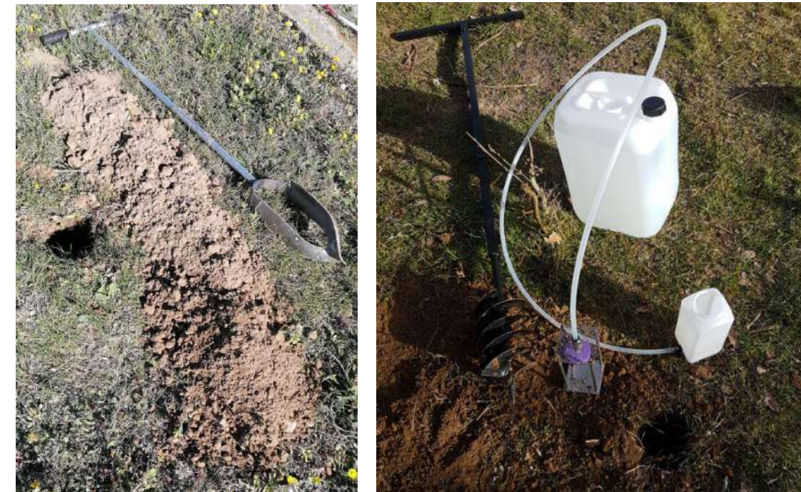
Figure 204 : Test de perméabilité de type Porchet : carottage du sol à la tarière et mise en place d'un infiltromètre
