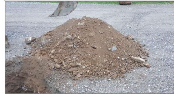
Sondage S101 et matériaux extraits
