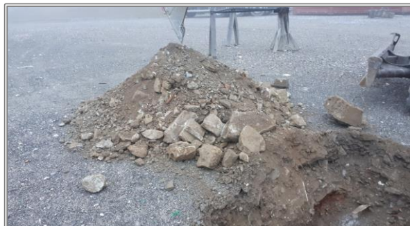
Sondage S102 et matériaux extraits
