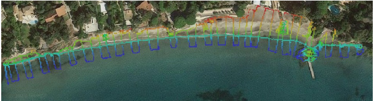
Figure 29 : Réalisation de 48 profils en travers
