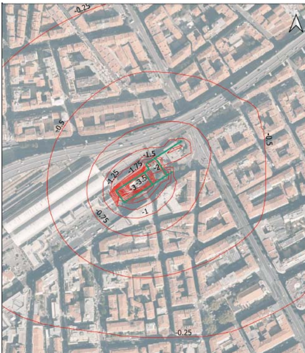
illustration 12 : Résultats modélisation hydrogéologique du rabattement de nappe - Projet Iconic (A LA SOURCE CONSEIL)
