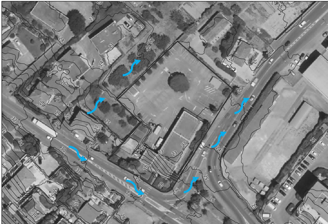
Figure 11 : Ruissellements aux abords de la parcelle du projet
