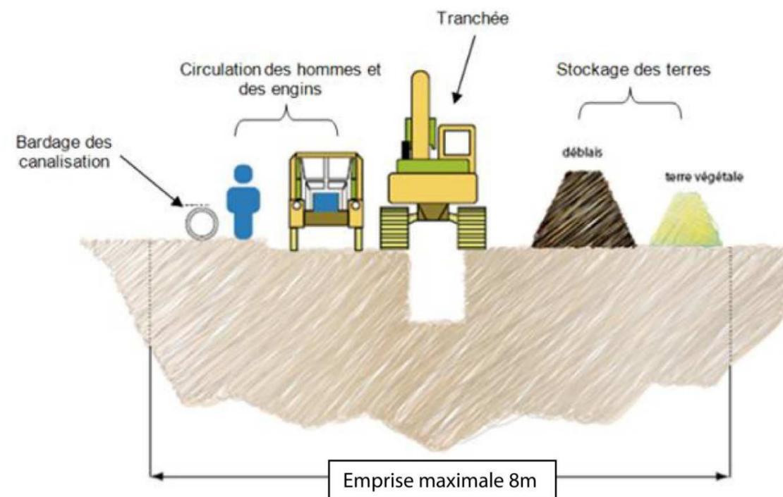
Figure 2 Coupe type et schématique d'organisation des travaux
