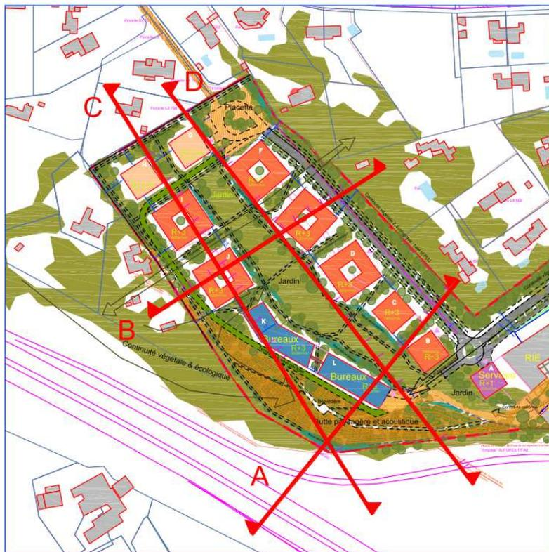
Les vues en coupes du relief sont présentées ci-après. Les cartographies verticales issues de la simulation sont réalisées suivant ces coupes A/B/C/D.
