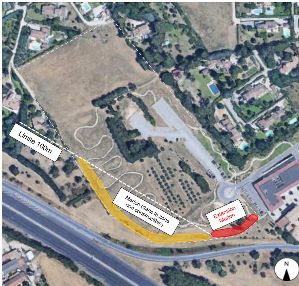
Pour les merlons théoriques, les différentes hauteurs de merlons envisagées (par rapport au sol du relief existant) sont : 4, 6 et 8m. La largeur en haut du merlon est de 2m. La pente prise en compte à l'extérieur du merlon (côté voies routières) est de 3/2. A titre d'exemple, le profil théorique du merlon de hauteur 4m est donné ci-après.
