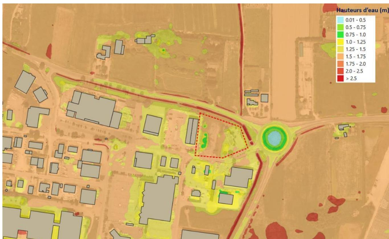
Illustration 20 : Hauteurs maximales de submersion modélisées pour le crue de référence
