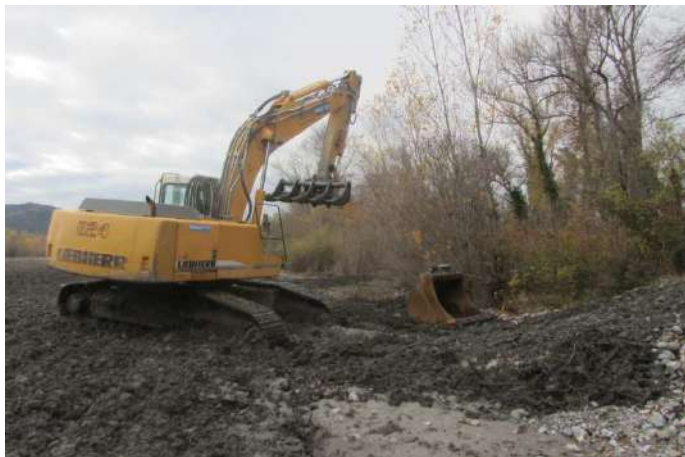
Pelles mécaniques équipées d'un godet fleco (= râteau = multi-ripper) classique et chargeur en arrière-plan
