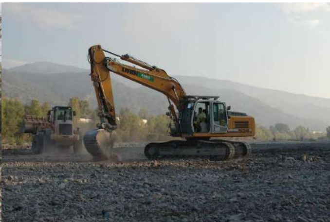
Pelles mécaniques équipées d'un godet fleco (= râteau = multi-ripper) classique et chargeur en arrière-plan
