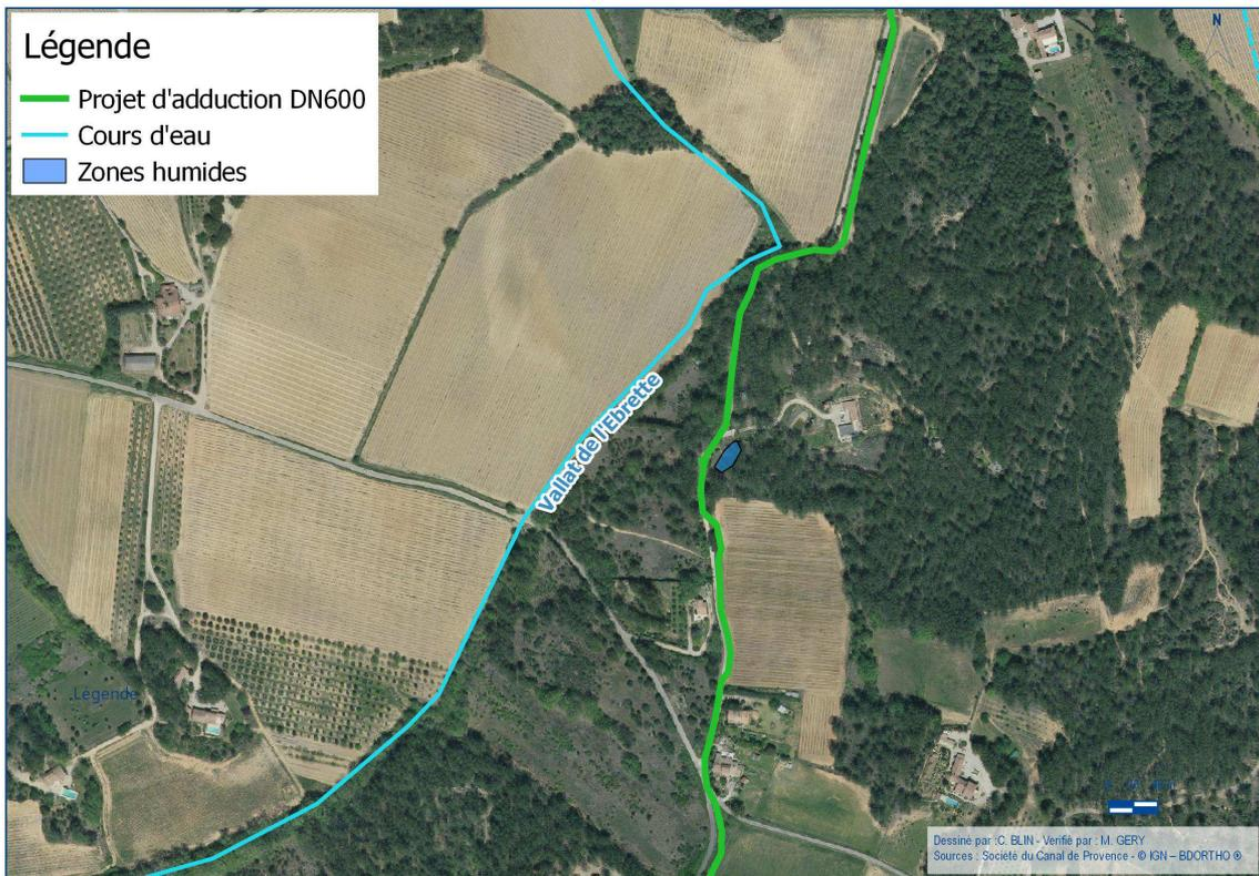
Figure 3 : Zoom sur la zone humide évitée par le tracé de la canalisation
