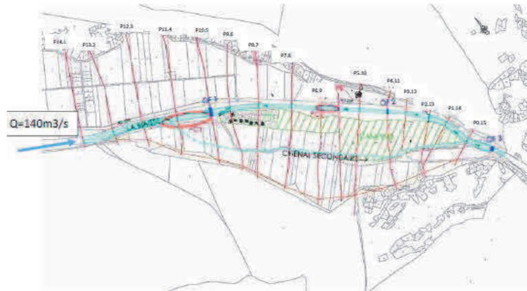
Figure 3: Localisation des profils de la modélisation hydraulique
