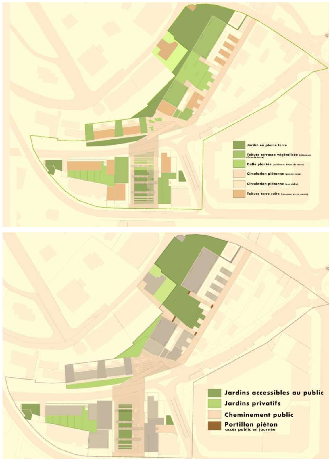
Figure 10 : Types de revêtements et usages des surfaces
