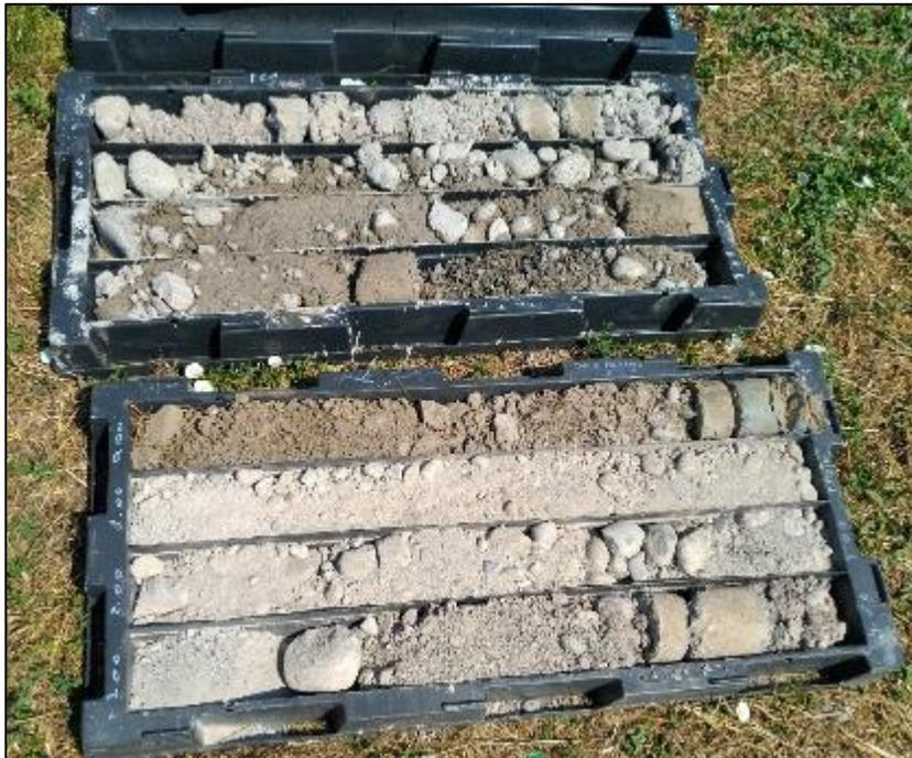
Photo 15 : Echantillons prélevés au sondage SC1 réalisé au sud-est du site
