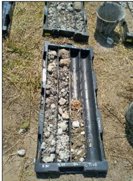
Photo 18 : Echantillons 8-10,5 m prélevés au sondage SC2 réalisé au nord-est du site
