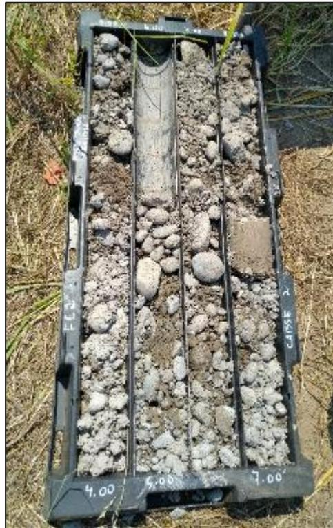
Photo 17 : Echantillons 4-8 m prélevés au sondage SC2 réalisé au nord-est du site
