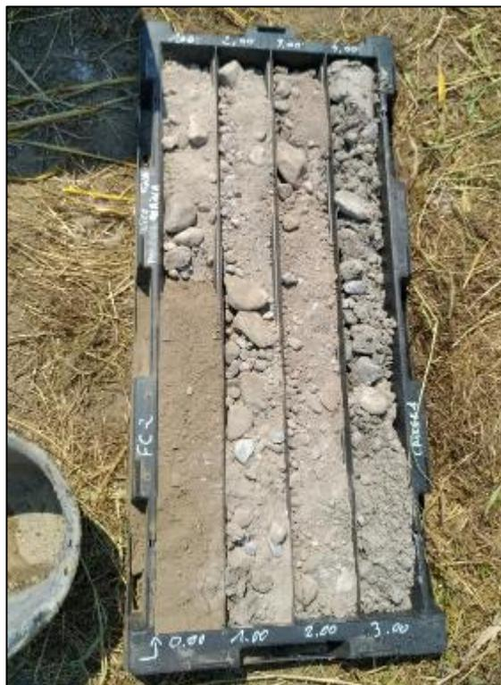
Photo 16 : Echantillons 0-4 m prélevés au sondage SC2 réalisé au nord-est du site
