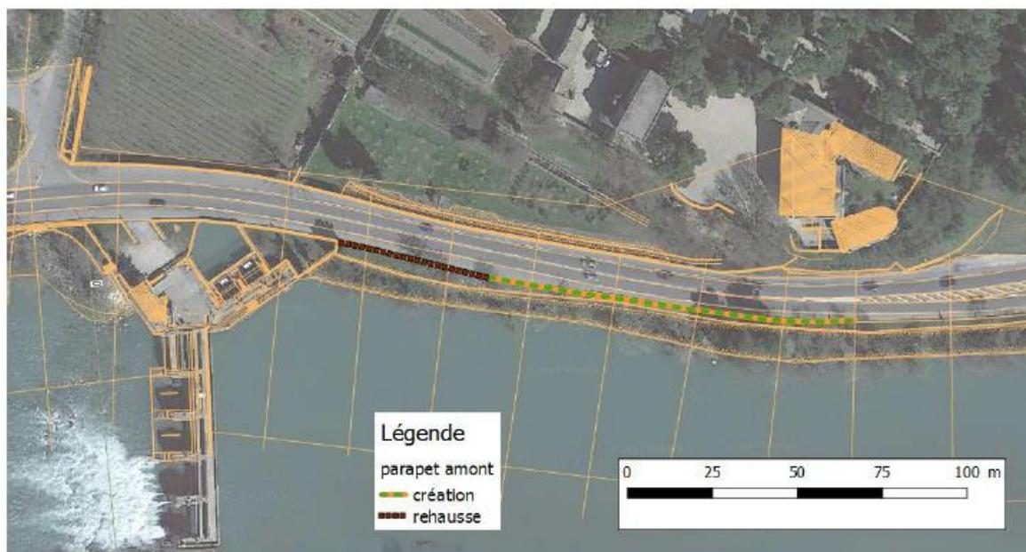
**Figure 4 : Travaux prévus en amont du barrage de Bonpas**
