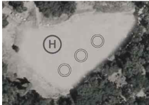
Figure 2 : hélistation de la Mort du Luc Une aire de pose et trois plots de stationnement
