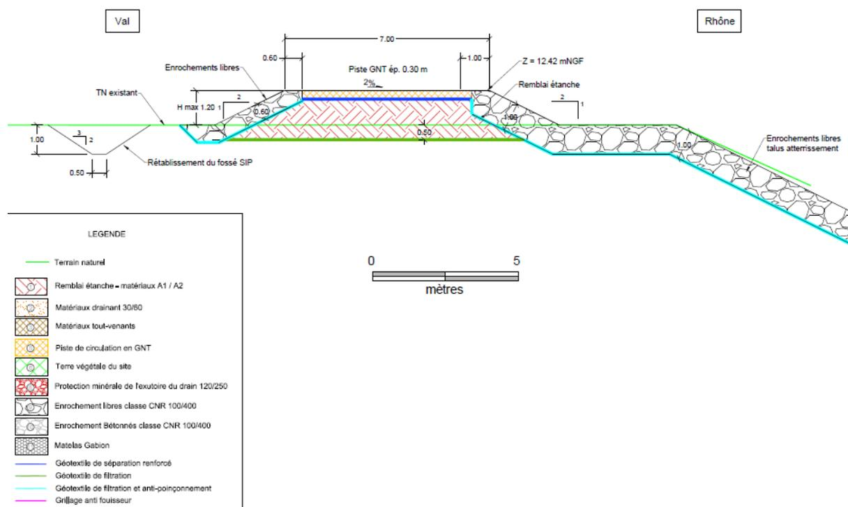
*Légende : Dans le cadre de la création de la digue entre Tarascon et Arles il est prévu la réalisation de la coupe type ci-dessus au droit du SIF de Tarascon, entre le pont de la RD90 et Fibre Excellence. Dans la continuité, une coupe type similaire sera mise en œuvre sur le secteur 2 (voir annexe 3) du projet de rehaussement du SIF de Tarascon. Les enrochements seront cependant remplacés par de la terre végétale.*
