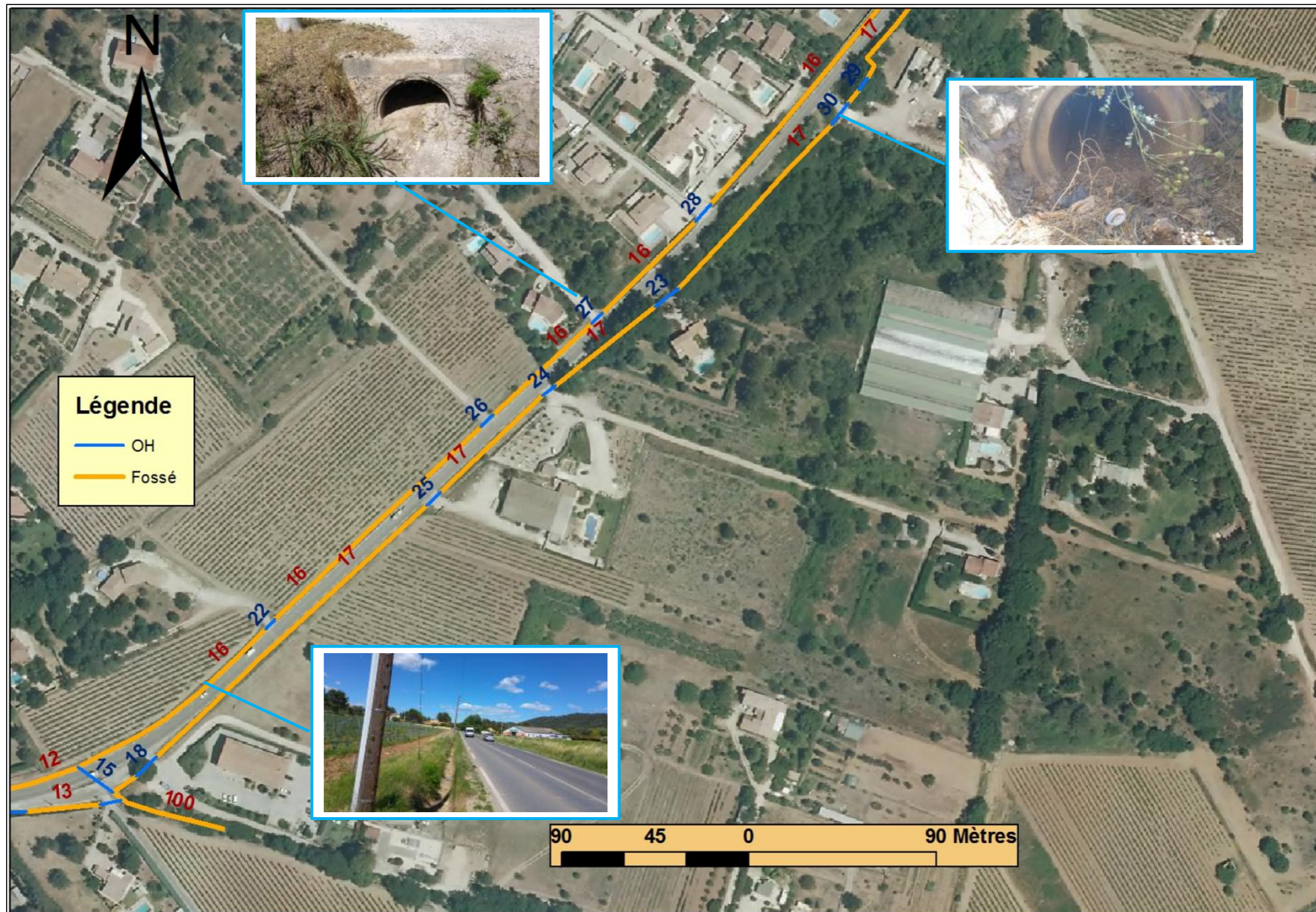
Figure 7 : Diagnostic des ouvrages hydrauliques existants : de l'usine de traitement des eaux vers le Réal Martin (sur une distance de 550 m environ)
