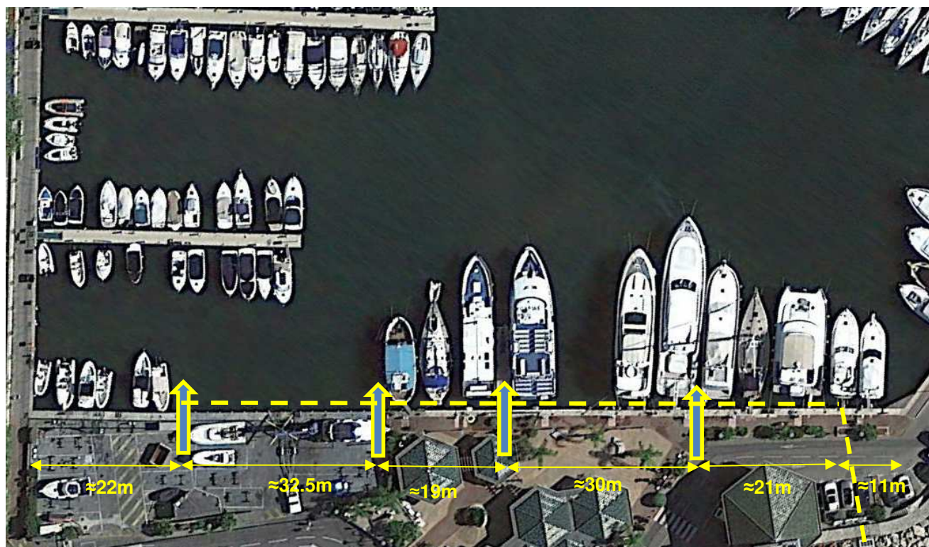
Position des points de sortie de la conduite-diffuseur ensouillée sous le terrain naturel
