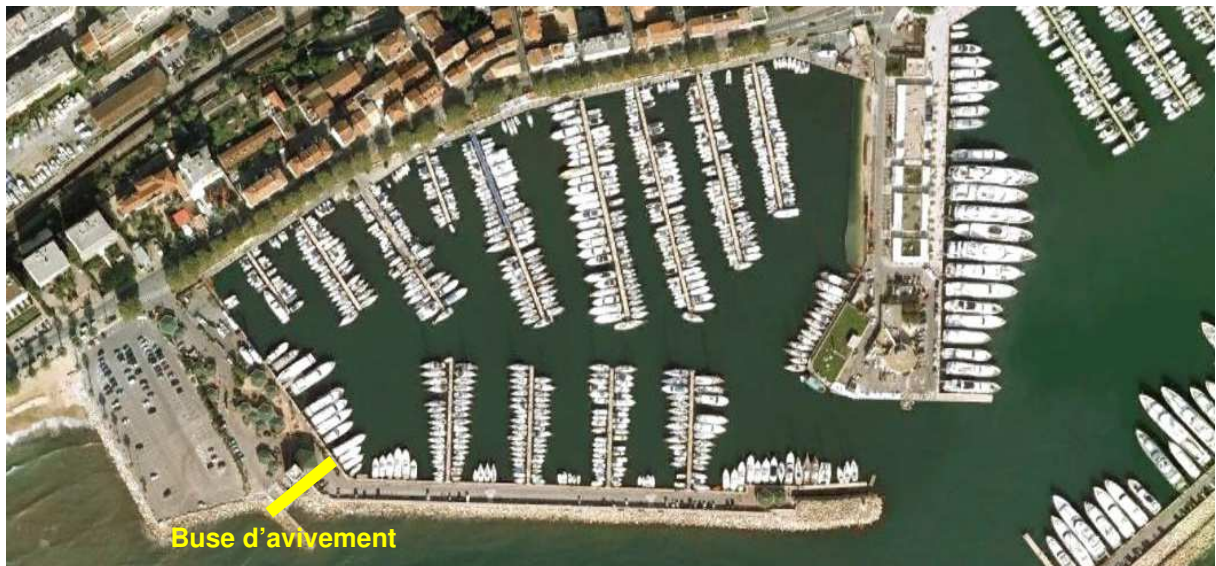
Buse d'avivement existante, diamètre 1000mm
