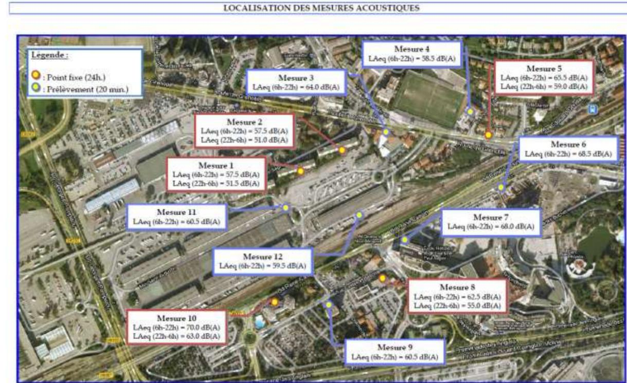
Figure 68 : Localisation des points de mesures acoustiques (CIA)
