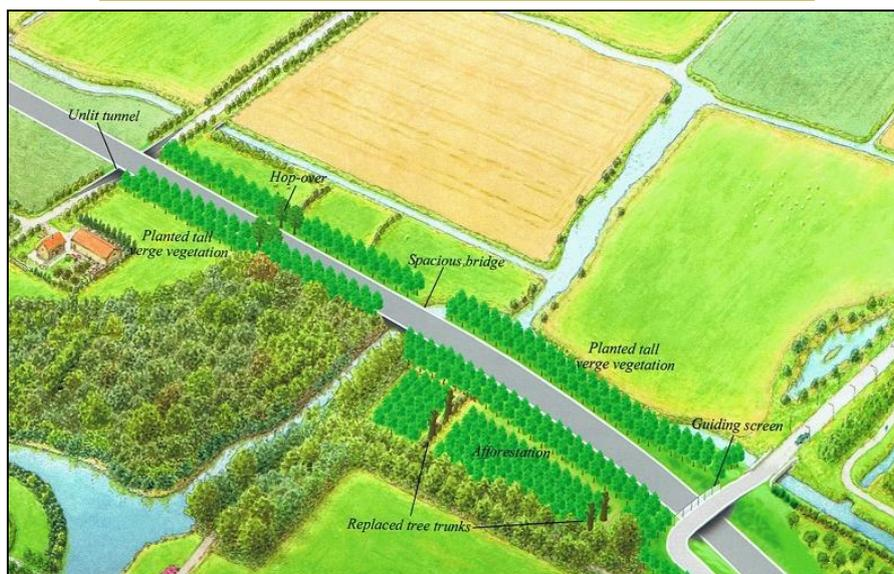
**Passage d'une chauve-souris par un Hop-over (image du haut) et exemples d'installation favorables aux chiroptères lors de la construction d'une route**
