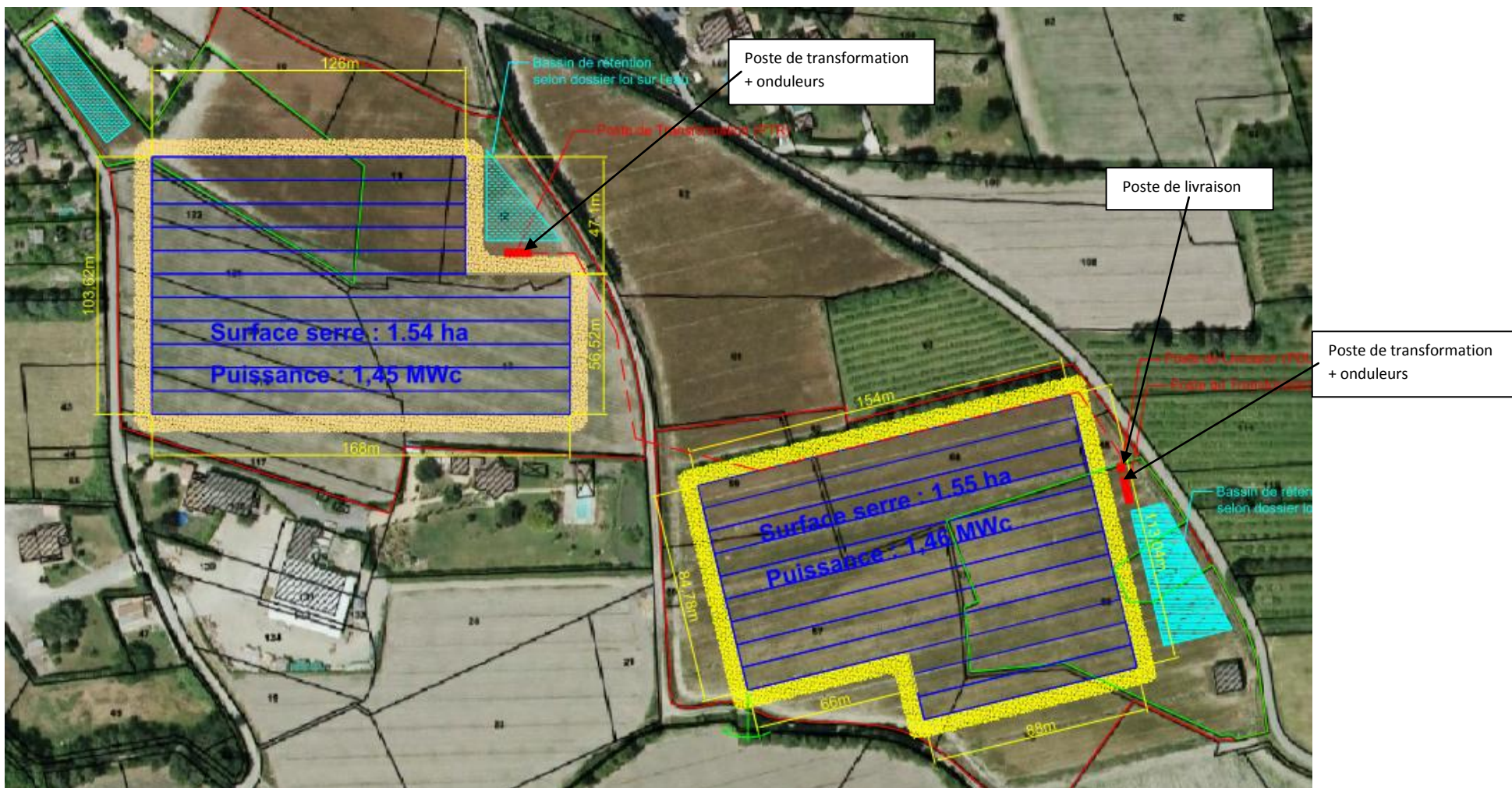
Figure 1 : Plan d'implantation des modules de la serre sur le site.
