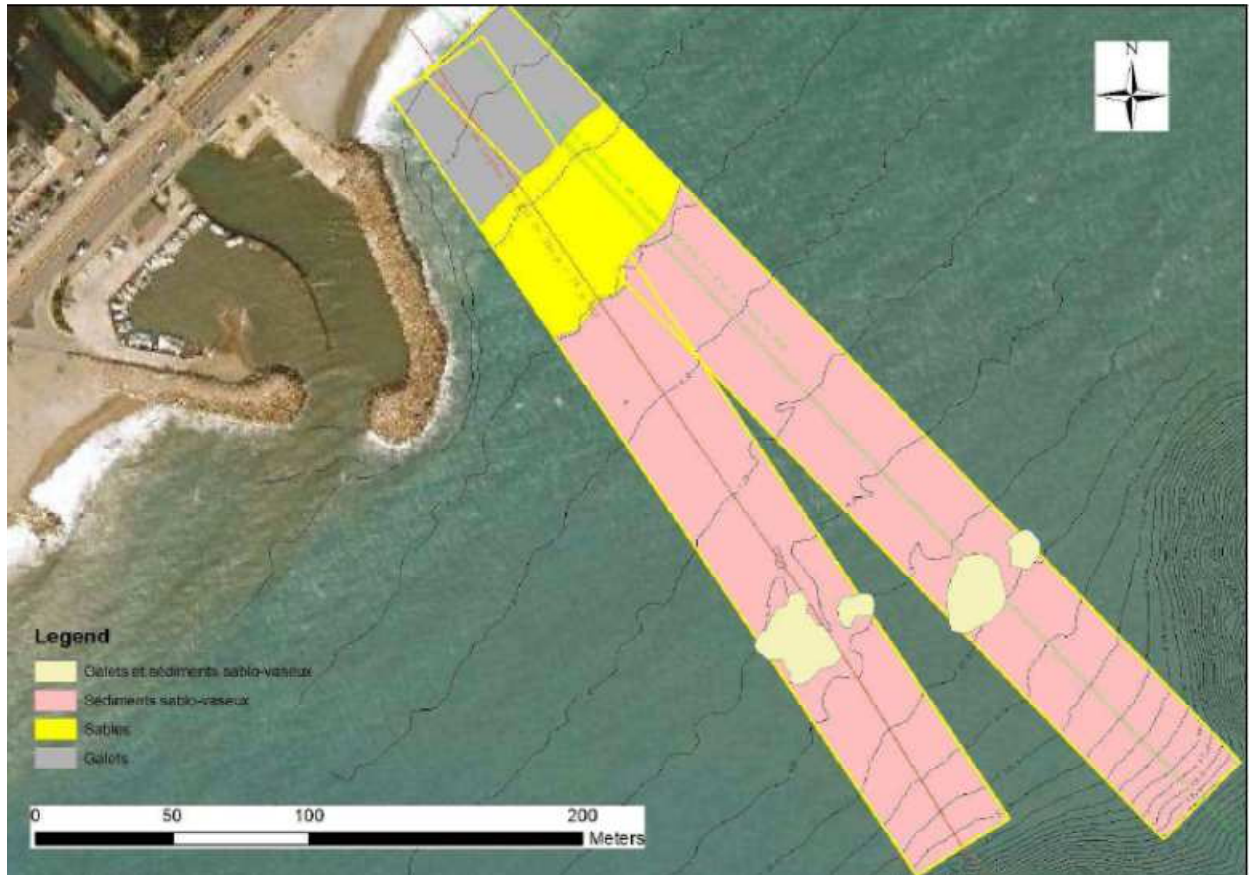
Figure 22 : Sédimentologie au niveau de la partie amont de l'émissaire
