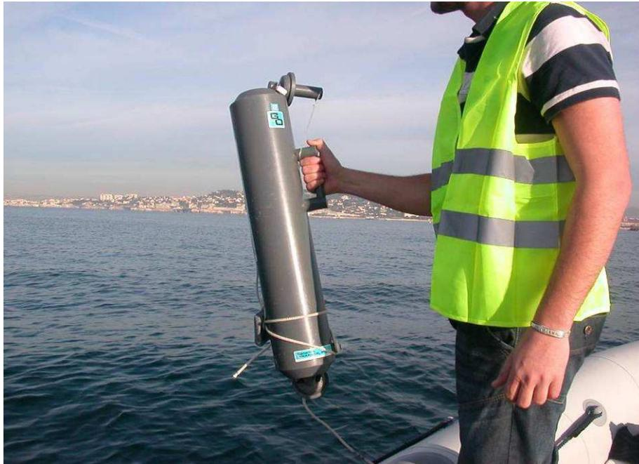
Photo 1 : Prélèvement d'eau à l'aide d'une bouteille Niskin
