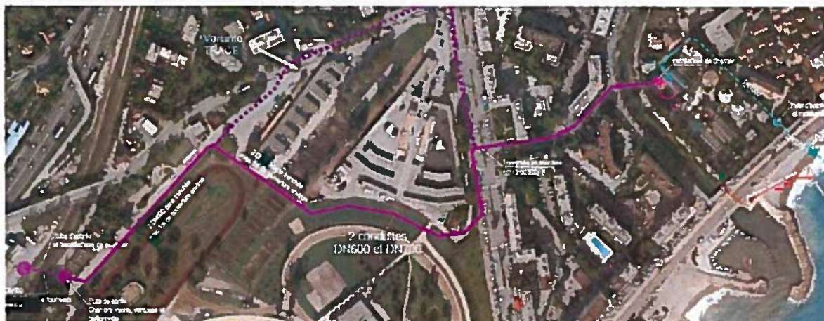
Projet d'implantation des ouvrages de transfert
