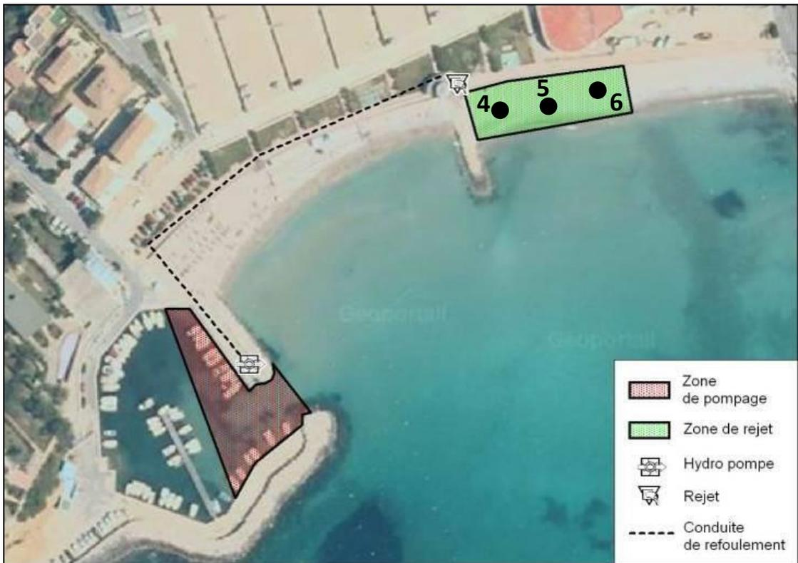
Les sédiments à draguer (Rouet) et ceux de la zone de dépôt (plage du Rouet) sont des sables de granulométrie proches. On constate que les sédiments de la plage sont légèrement plus grossiers que ceux du port du Rouet, avec un mode de 570 µm pour la plage et compris entre 271 et 296 µm pour le port.
