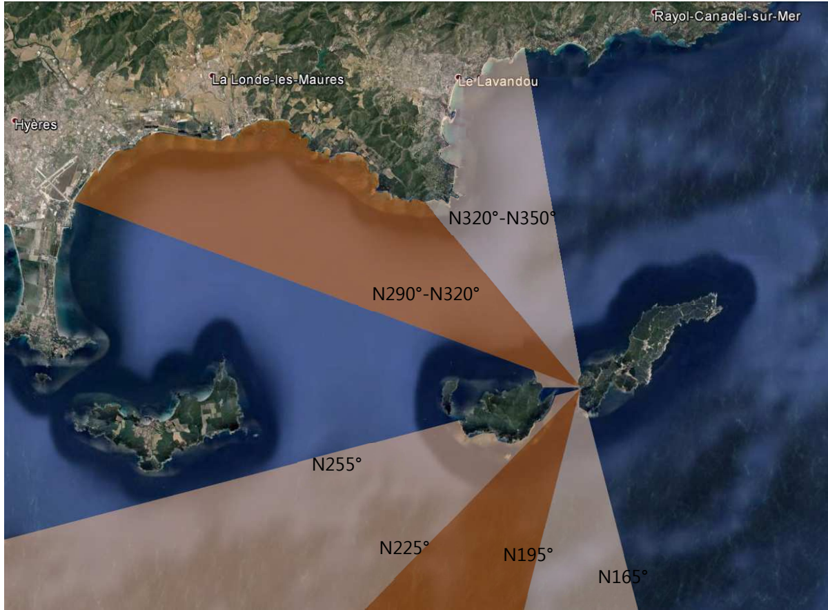
Secteurs d'exposition du site d'étude aux houles du large et aux clapots de vent (Source image : Google Earth).
