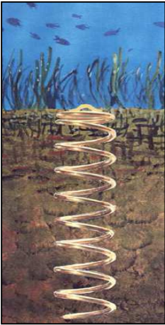
Principe d'une ligne de mouillage et différentes ancres écologiques de type HARMONY
