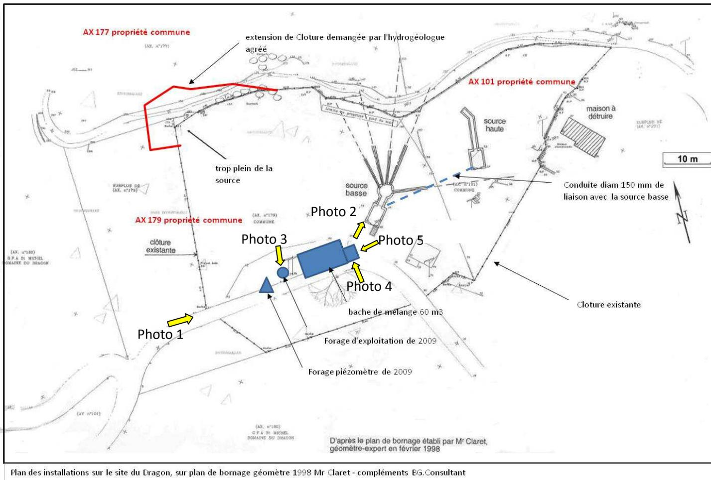
**FIGURE 1:** Situation du forage et des installations associées au sein du périmètre de Protection Immédiate déterminé par l’Hydrogéologue Agréé sur plan de bornage du géomètre.
