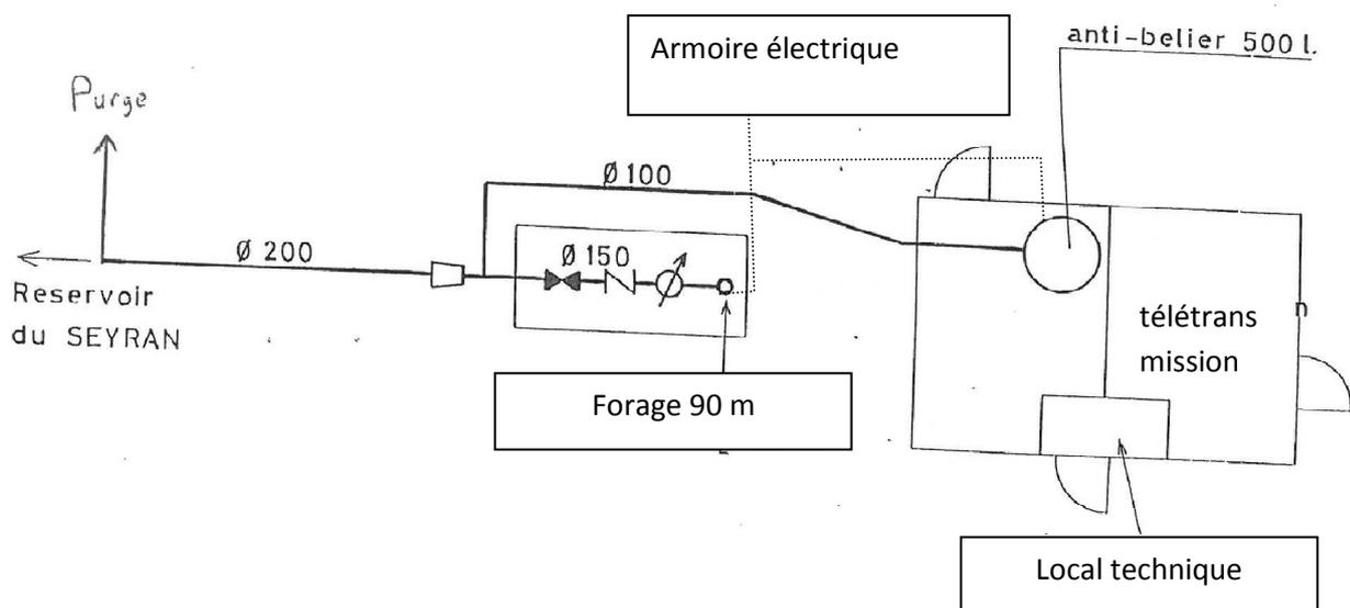
**Figure 1:** *plan des installations présentes sur le périmètre de protection immédiate du Pont d'Aups 2*
