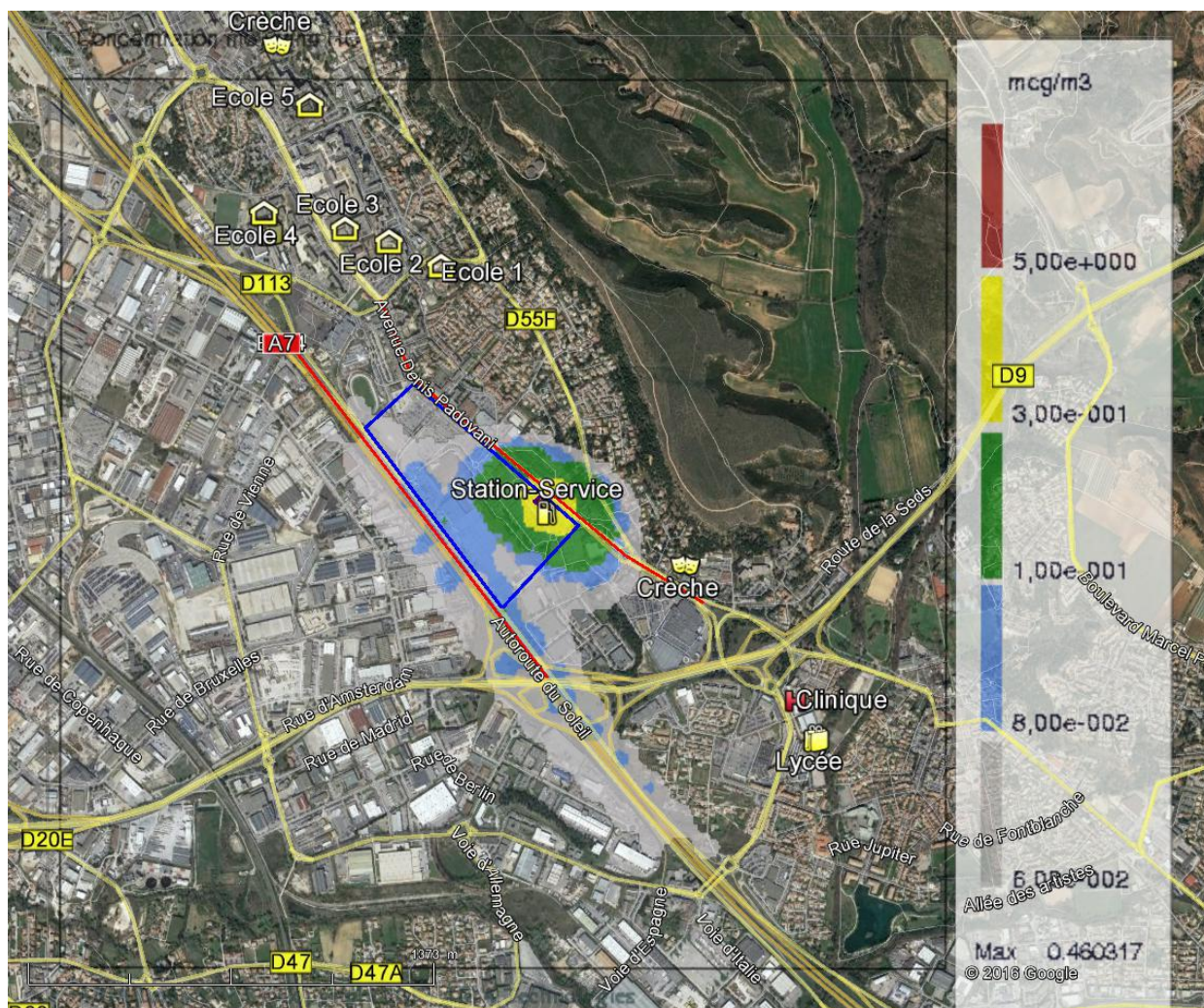
Figure 16 : Iso-concentrations de la dispersion des émissions d'hydrocarbures provenant de la zone commerciale et sources proches
