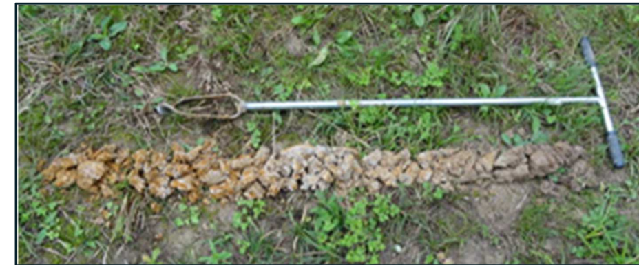
FIGURE 16 – SONDAGE À LA TARIÈRE MANUELLE – EGIS ENVIRONNEMENT
