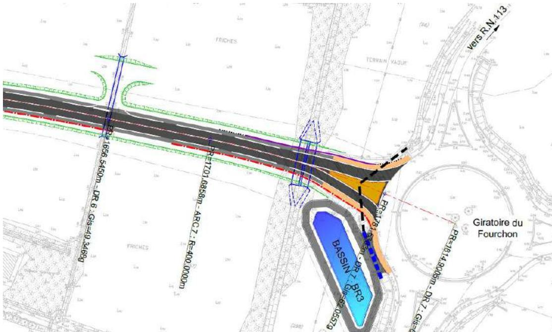
L'accès à la propriété riveraine au sud du projet est rétabli sous la culée sud de l'OA1 (gabarit de 4m de largeur par 4 m de hauteur). Le rétablissement sous l'ouvrage est mutualisé avec la piste d'entretien.
