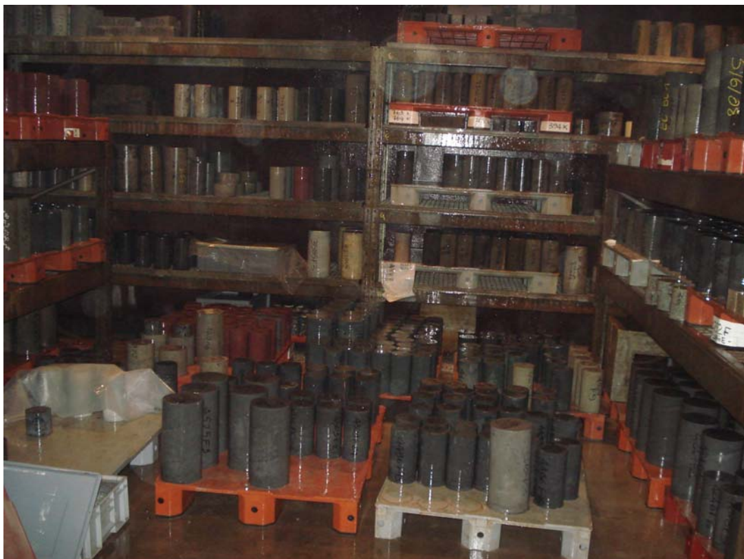
Figure 24: Tests de lixiviation sur des carottes de béton, les eaux sortant de cet essai passent par un bac de décantation avant d'être rejetées dans l'Arc.
