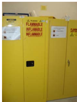
Figure 31 : Armoire de stockage ATEX dans le bâtiment L2 des laboratoires d'essai
