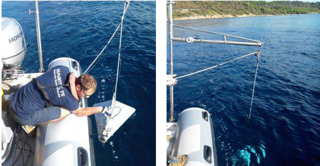
Figure 7 : Système tracté de vidéo sous-marine géo-référencée
