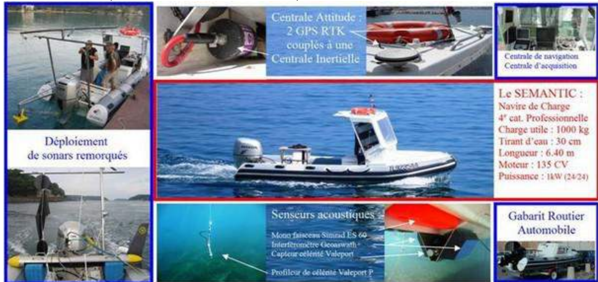
Figure 5 : Le SEMANTIC : un navire océanographique conçu pour les petits fonds marins
