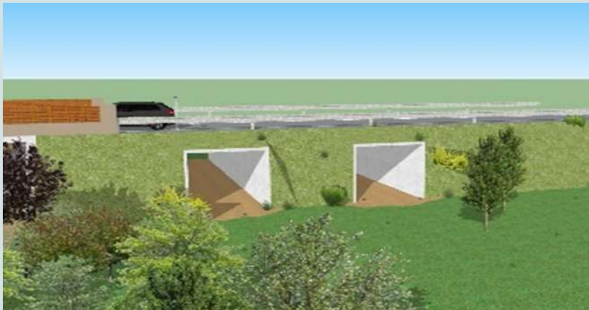
Figure 96 : Exemple de passage à faune sous-infrastructure routière (sans entonnement ici)
