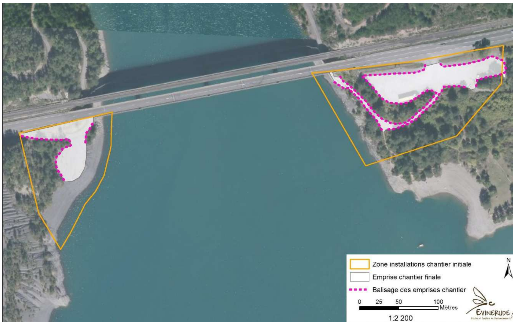
Figure 73 : Cartographie de la mesure E2 - Limitation et balisage des emprises chantier.
