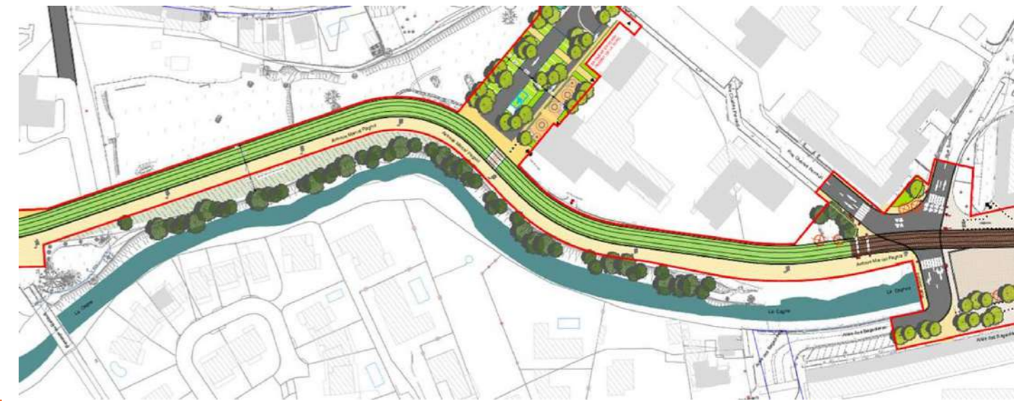
Figure 39 : Restauration de la rive gauche de la Cagne, lors des travaux de création de la ligne 4 du tramway métropolitain
