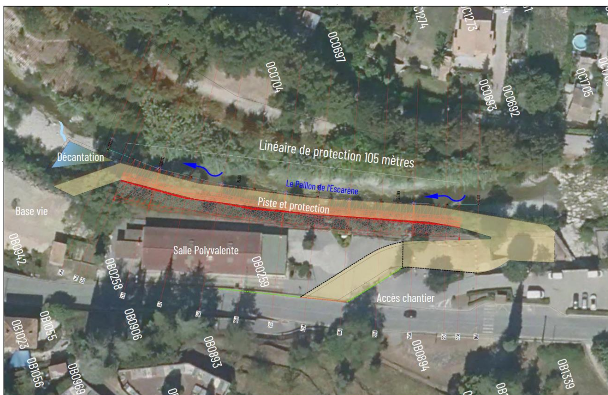
Figure 24 : Localisation des installations de chantier (Source : SMIAGE)
