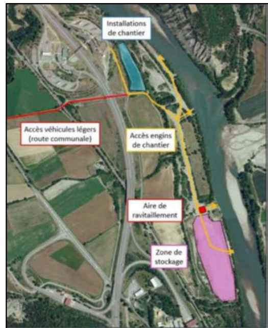
Figure 9 : Localisation des accès et des installations de chantier en rive droite
