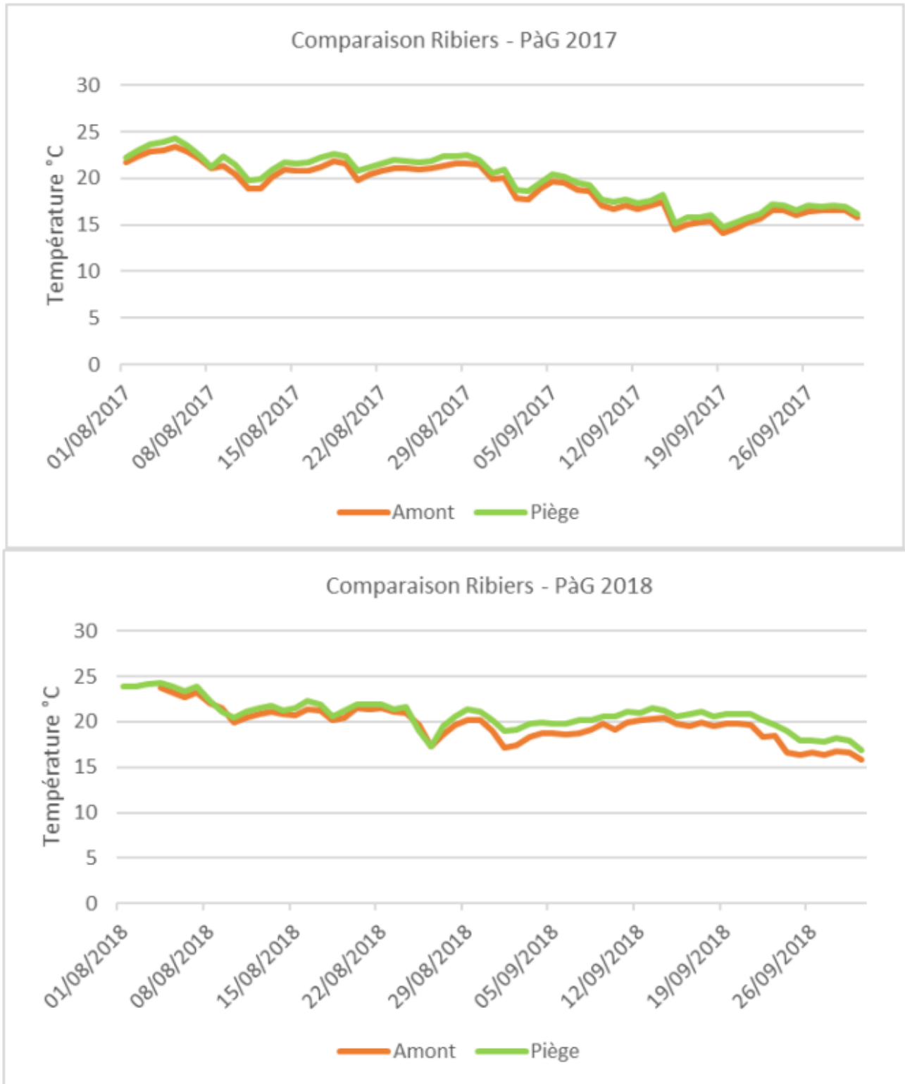
Figure 25 : Comparaison des températures moyennes journalières entre août et septembre entre Ribiers et le piège à graviers – période 2017-2018 (Source : d'après les données GAY Environnement)
