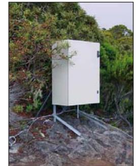
*Extensomètre mesurant l'écartement entre les deux parois de la crevasse. Les mesures sont enregistrées automatiquement dans la centrale d'acquisition (à droite).*
