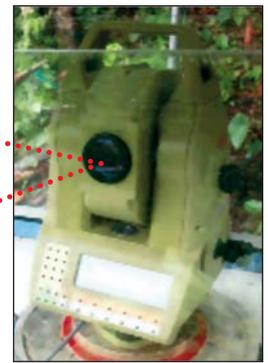
*Les cibles "repères" (à droite) sont positionnées sur la surface à surveiller. Le théodolite est réputé posé sur un socle fixe, et pointe automatiquement et périodiquement son faisceau laser vers les cibles.*
