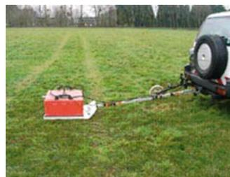
**Acquisition du profil :** le radar est tracté par un véhicule ou à la main le long d'un tracé donné.
