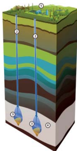
Coupe schématique d'un stockage en cavités salines
