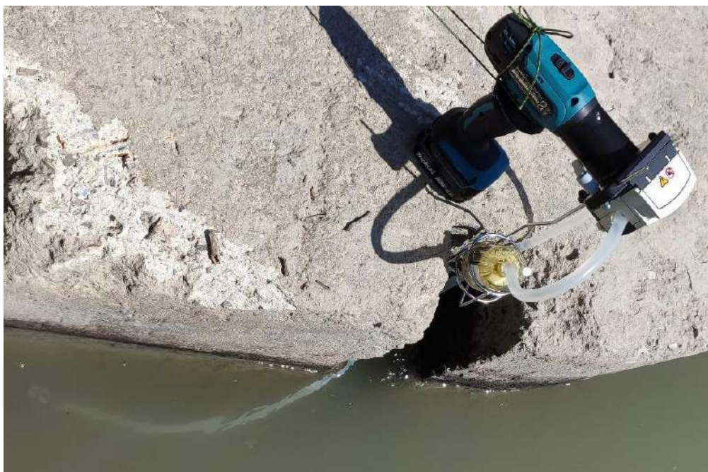
Matériel de prélèvement et de filtration de l'eau en vue de l'analyse de l'ADNe, soit une pompe péristaltique, un tuyau et une capsule de filtration stériles © Biotope
