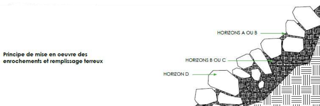
Figure 12 : Présentation de la disposition des futurs enrochements
