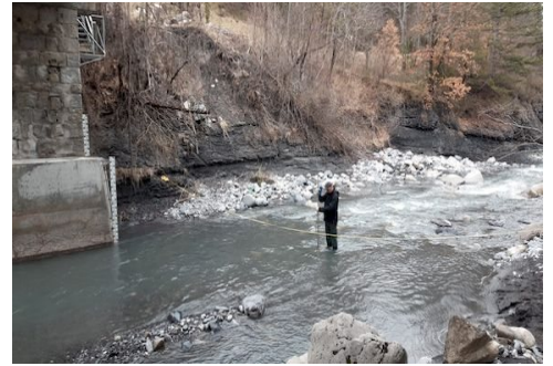
Jaugeage à Villeeneuve d'Entraunes sur le VAR amont (06) (Source : DREAL PACA)
