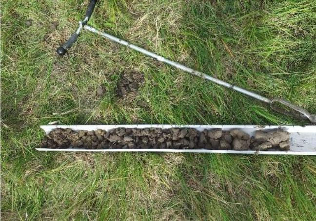
Sol humide de type IVd du sondage n°5, avec apparition de la nappe dès 90cm
