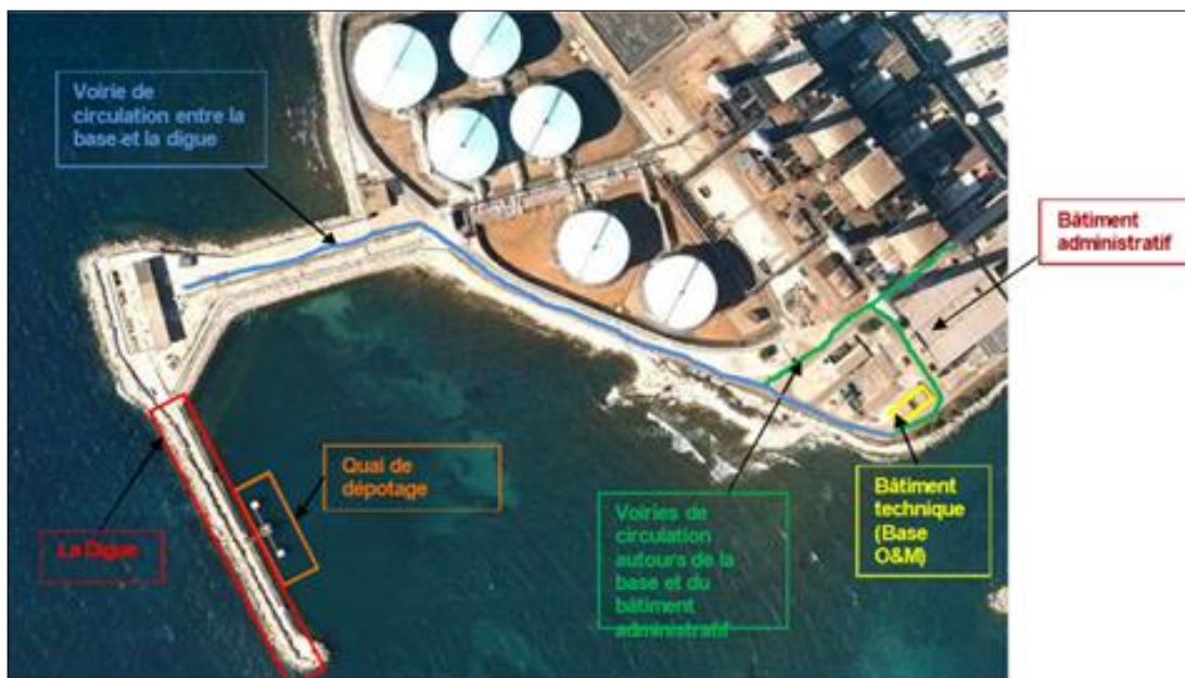
Figure 3-24 : Schéma d'implantation de la base O&M courante (PEOPGL, 2017)
